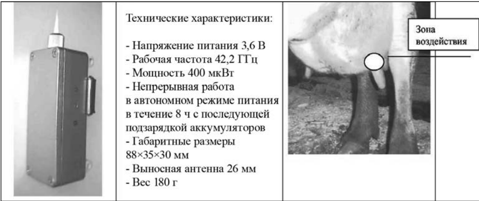
Рисунок 2. Аппарат «ПОРТ-ЭЛМ/НН» — источник ЭМИ КВЧ мм-диапазона и зона воздействия излучения на вымени коровы
