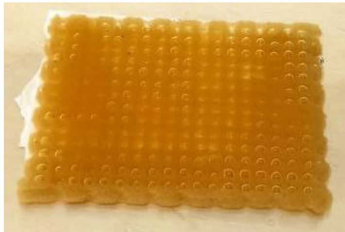
Рис. 2. Внешний вид 3D-бионапечатанного конструкта, стабилизированного \text{Ca}^{2+}
